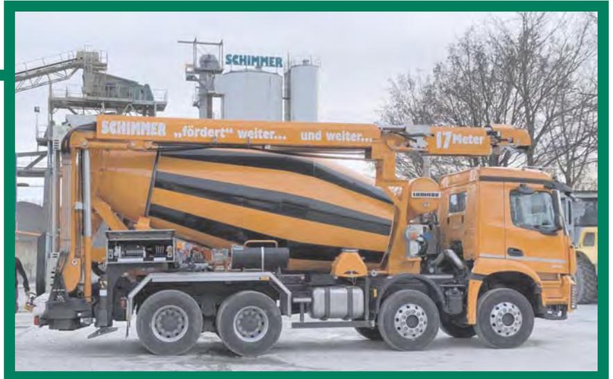
**Beton mit fester Konsistenz** kann nicht gepumpt werden. An dieser Baustelle wird der Untergrund befestigt. Das Material kann mit dem LTB auf der ganzen Fläche verteilt werden ohne das Fahrzeug zu bewegen. Die nachfolgenden Fahrmischer geben ihr Material ebenfalls auf das Band. Der Fahrer bedient das LTB von beliebiger Stelle aus und kann bei Bedarf das Fahrzeug auch mittels Start/Stop-Funktion abstellen oder starten.
