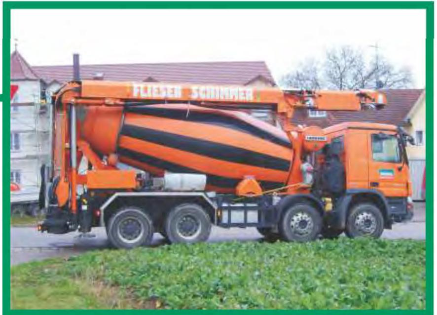
**Beton mit fester Konsistenz** kann nicht gepumpt werden. An dieser Baustelle wird der Untergrund befestigt. Das Material kann mit dem LTB auf der ganzen Fläche verteilt werden ohne das Fahrzeug zu bewegen. Die nachfolgenden Fahrmischer geben ihr Material ebenfalls auf das Band. Der Fahrer bedient das LTB von beliebiger Stelle aus und kann bei Bedarf das Fahrzeug auch mittels Start/Stop-Funktion abstellen oder starten.
